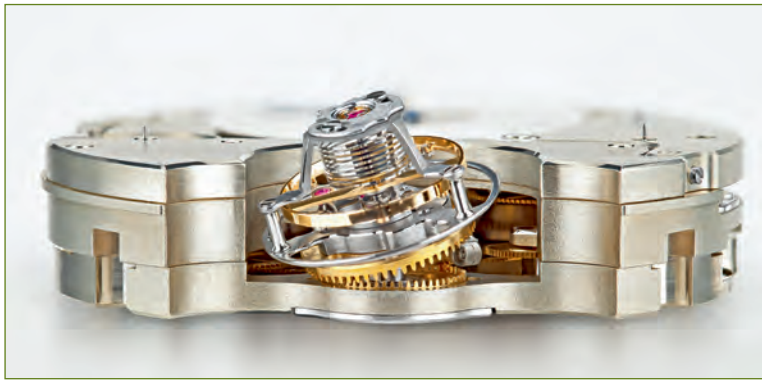
Duomètre à Sphérotourbillon 双翼立体双轴陀飞轮腕表搭载的382型机芯, 配备双轴陀飞轮装置: 陀飞轮围绕与框架同心的第一个轴转动, 同时围绕与框架轴心呈20度角的第二个轴转动。
