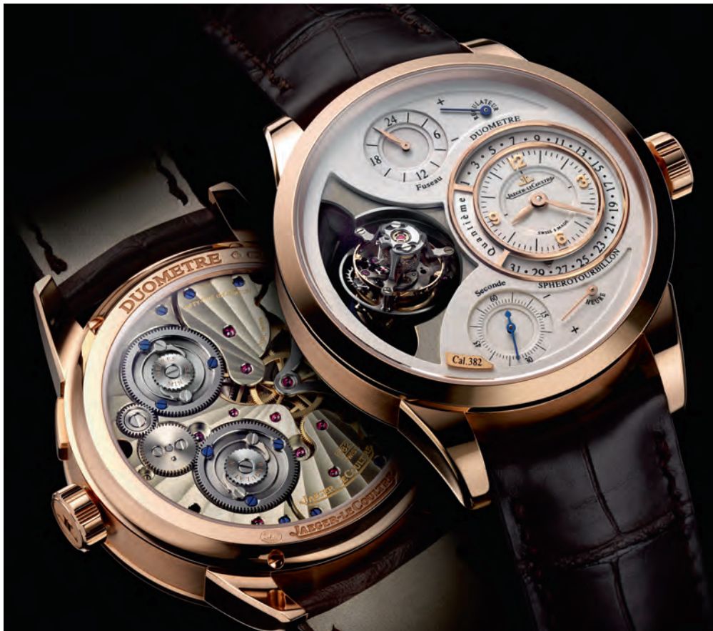
Duomètre à Sphérotourbillon 双翼立体双轴陀飞轮腕表搭载的382型机芯, 配备双轴陀飞轮装置: 陀飞轮围绕与框架同心的第一个轴转动, 同时围绕与框架轴心呈20度角的第二个轴转动。
