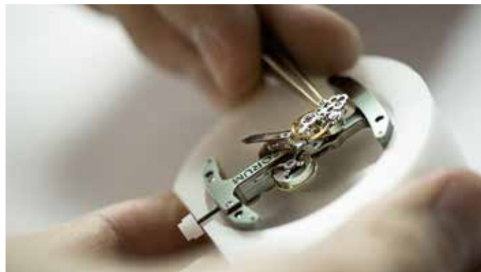
Das automatische Aufzugssystem der Ti-Bridge Automatic Dual Winder mit seinen zwei linear angeordneten Schwungmassen, von Corum patentiert.
