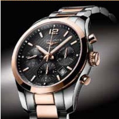
Boîtier en acier et or rose 18 ct de 41 mm de diamètre avec fond saphir. Mouvement mécanique à remontage automatique avec mécanisme de chronographe à roue à colonnes, calibre L688.2 (ETA A08.L01), 28'800 alternances/heure. Réserve de marche de 54 heures. Fonctions heures, minutes, petite seconde, chronographe, date. Cadran noir avec aiguilles, chiffre et index appliques luminescents. Bracelet en acier et or rose 18 ct avec boucle déployante. Etanche à 50 mètres.
