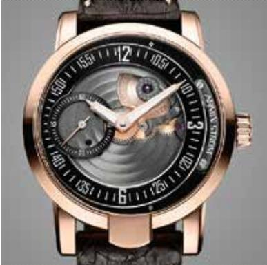
Boîtier en or rose 18 ct de 43.40 mm de diamètre avec fond saphir. Mouvement mécanique de manufacture à remontage manuel, calibre AMW11 Armin Strom. Réserve de marche de 120 heures. Fonctions heures, minutes, petite seconde. Cadran noir avec appliques apposées, affichage décentré. Bracelet en cuir d'alligator « horn back » avec boucle ardillon en or rose 18 ct, livré avec bracelet additionnel en caoutchouc. Etanche à 50 mètres. Edition limitée à 100 exemplaires.
