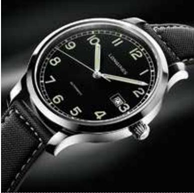
Boîtier en acier de 40 mm de diamètre avec couronne cannelée aplatie. Mouvement mécanique à remontage automatique, calibre L619.2 (ETA 2892/A2), 28'800 alternances/heure. Réserve de marche de 42 heures. Fonctions heures, minutes, secondes, date. Cadran noir mat avec aiguilles rhodiées satinées et chiffres arabes luminescents. Bracelet synthétique noir. Etanche à 30 mètres.
