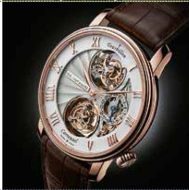
Boîtier en or rouge de 44.6 mm de diamètre avec fond saphir. Mouvement mécanique sécurisé à remontage manuel, calibre 2322 avec tourbillon et carrousel volants, 379 composants dont 2 spiraux en silicium. Réserve de marche de 168 heures. Fonctions heures, minutes, date, indication de la réserve de marche côté ponts. Cadran avec tour d'heure en émail Grand Feu blanc et chiffres romains en or 5N. Bracelet en cuir d'alligator doublé alzavel avec boucle déployante. Etanche à 30 mètres.
