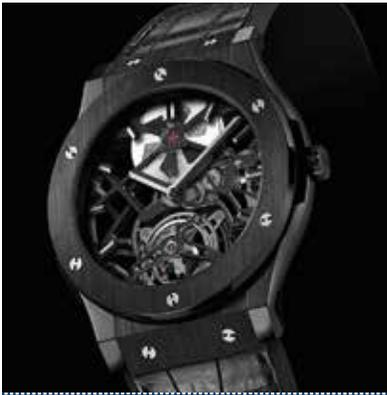
Boîtier en céramique noire polie et satinée de 45 mm de diamètre avec fond saphir. Mouvement manufacture tourbillon squeletté à remontage manuel, calibre MHUB6010. H1.1, 21'600 alternances/heure. Réserve de marche d'environ 120 heures. Fonctions heures, minutes. Cadran saphir, index et aiguilles polis traités noir. Bracelet en alligator noir cousu sur caoutchouc avec boucle déployante en acier traité PVD noir. Etanche à 30 mètres. Edition limitée à 99 pièces numérotées.
