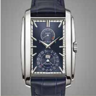
Boîtier en or gris avec fond saphir, 32.4 x 46.9 mm. Mouvement mécanique à remontage manuel, calibre rectangulaire 28-20 REC 8J PS IRM C J. Fonctions heures, minutes, petite seconde, indicateur de réserve de marche de 8 jours, jour par guichet, date par aiguille. Cadran bleu soleil mat, index appliques or. Bracelet en cuir d'alligator à écailles carrées bleu marine brillant, cousu main, avec boucle ardillon. Étanche à 30 mètres.
